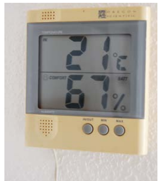
Abb. 6: Digitales Thermohygrometer mit Außenfühler: Hilfreich für die Kontrolle des Raumklimas, aber interpretationsbedürftig. Zeitpunkt der Aufnahme: Ein Sommermorgen. Alles im „grünen Bereich“. Die gleichen Werte im Winter? Ein eindeutiger Hinweis auf Lüftungsbedarf, s. Abb. 7. Foto: R. Borsch-Laaks
