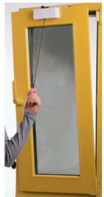
Abb. 3: Kippfenster mit automatischer Schließvorrichtung. Durch Ziehen an der Kordel wird die Feder des Schließmotors gespannt. Die Öffnungszeiten können auf 5 bis 60 Minuten eingestellt werden. (Bild: Michael Wolf, TK-Plan).
