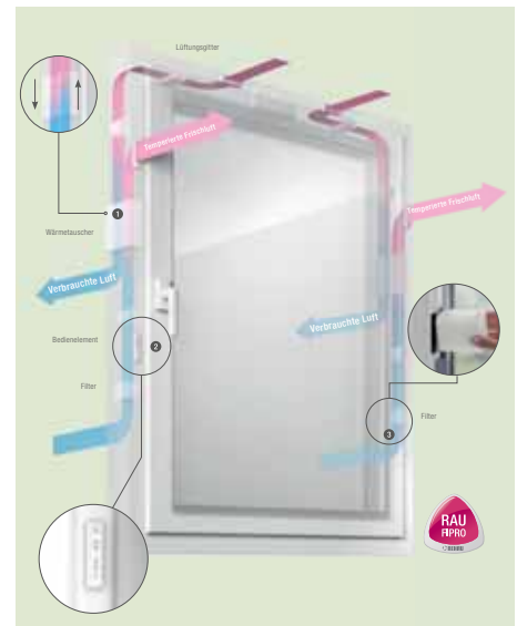
Abb. 6: Das Geneo Lüftungsfenster mit Wärmerückgewinnung Werkfoto: Fa. REHAU
