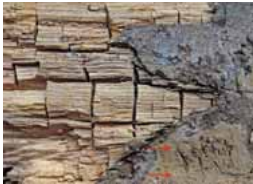
Abb. 1: Brauner Kellerschwamm ( Coniophora puteana ): Braunfäule mit grobem, fein untergliedertem Würfelbruch unter einer intakteren Holzoberfläche; auf dieser unscheinbare, braune, schwach warzige Fruchtkörper (!).
