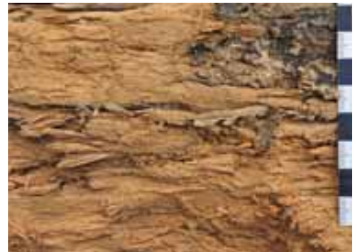
Abb. 2: Mycelreste des Ausgebreiteten Hausporlings ( Donkioporia expansa ): Weißfäule mit faserigem Bruch-/Abbaubild; Maßstab mit Zenti- und Millimetern.
