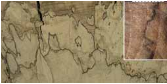
Abb. 15: Weißfäule/Marmorfäule: Das Holz ist von schwarzen Demarkationszonen durchzogen; Eckbild: braune Verfärbung an Teakholz aufgrund von Einlagerungen des Baumes (kein Fäuleschaden).
